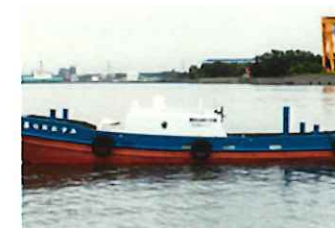
第七おおすみ（着火船） 全長7.60m 全幅2.60m 深さ0.90m 総トン数2.50t 馬力155ps×1
