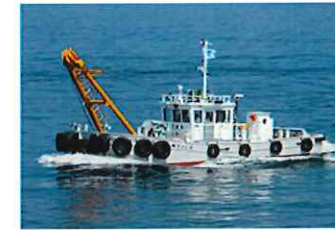
きりしま（揚船） 全長15.5m 全幅6.0m 深さ1.85m 総トン数19t 馬力575ps×2 基吊能力8.0t
