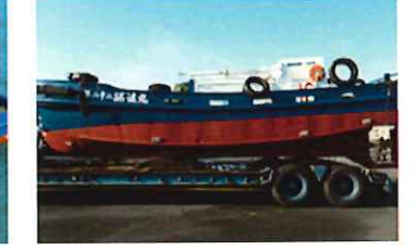
第二十二拓進丸（着火船） 全長9.50m 全幅3.30m 深さ1.05m 総トン数5t未満 馬力250ps×1 吊能力3.0t
