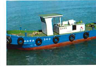
おおすみ340（着火船） 全長9.5m 全幅3.0m 深さ1.3m 総トン数5t未満 馬力340ps×1基
