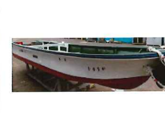
ひゅうが（伝馬船） 全長6.40m 全幅1.56m 深さ0.60m 総トン数0.60t 馬力50ps×1
