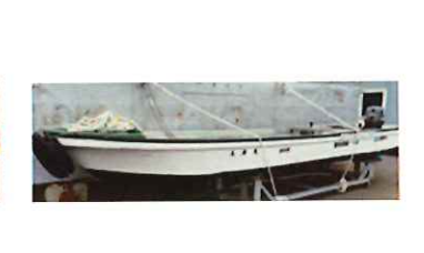
さつま（伝馬船） 全長5.63m 全幅1.45m 深さ0.60m 総トン数0.4t 馬力30ps×1
