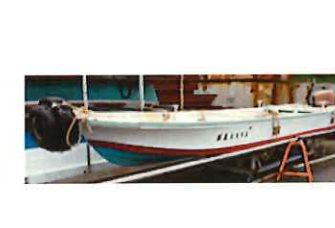
おおすみ（伝馬船） 全長6.72m 全幅1.72m 深さ0.55m 総トン数0.6t 馬力40ps×1
