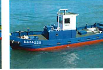
おおすみ220（着火船） 全長9.5m 全幅3.2m 深さ1.0m 総トン数5t未満 馬力220ps×1基
